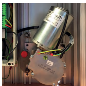
In hoogte verstelbaar motor met aandrijf wiel
